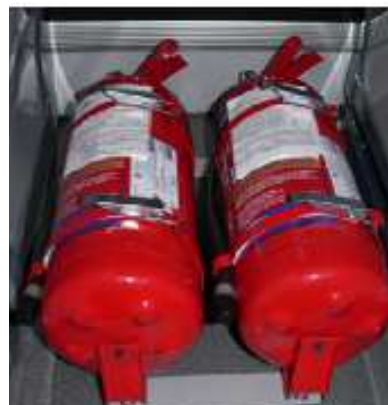
Umístění hasicích přístrojů na pravém předním podběhu u trolejbusu 26 Tr (Solaris)
