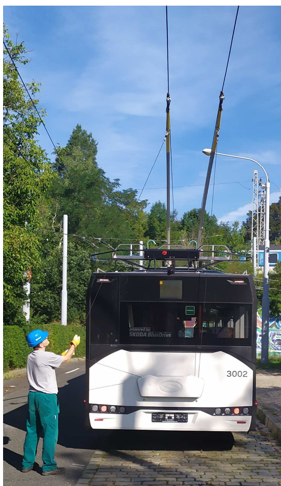
Obrázek 78 Manuální odpojení trakčních obvodů – lit. [41]
