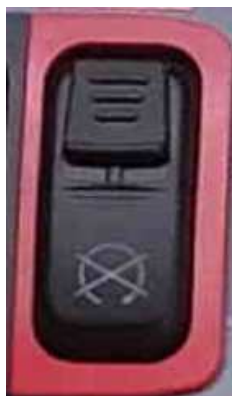
Obrázek 73: Spínač nouzového odpojení trakčních obvodů SOR. Ovládání je shodné se spínačem ve vozech s karosérií Solaris – lit.[26]
