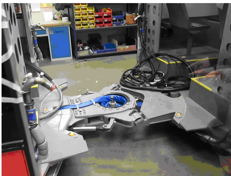
Obrázek 14: Kloub ve spoji kloubového autobusu SOR je shodný s trolejbusem. Na snímku je vidět kapalinový válec, který tlumí a omezuje vytáčení kloubu, a spojovací vedení mezi díly trolejbusu (chladicí kapalina pro topení, tlakový olej pro pomocné funkce, elektrická vedení a vedení tlakového vzduchu)
