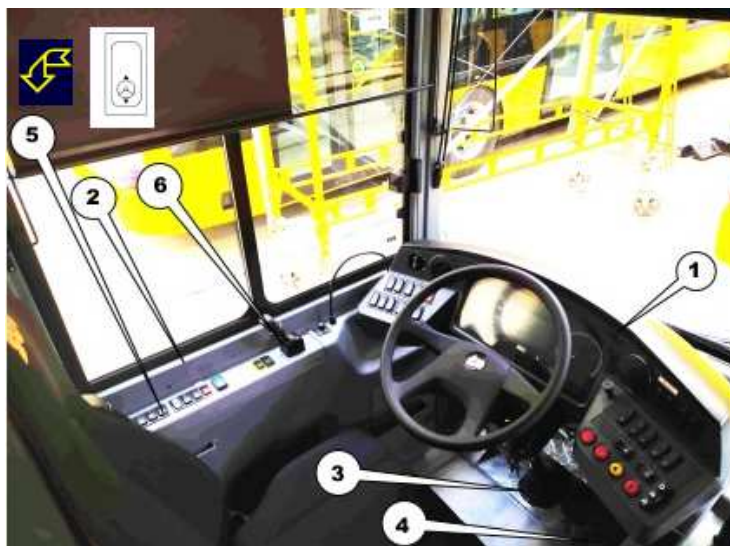
Obrázek 32: Tlačítko odblokování pohybu sloupku řízení trolejbusu SOR (5) – lit. [23] (Popis: hlavní přístrojový panel (1); boční přístrojový panel (2); brzdový pedál (3); pedál akcelérátoru (4); uvolňování sloupku volantu (5) tlačítko v podlaze nebo elektrickým spínačem– lit. [25,26])
