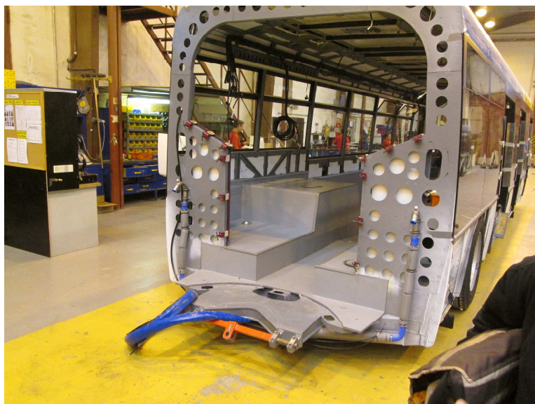
Obrázek 15: Přední část kloubového autobusu ve výrobě. Na snímku je dobře vidět přední část spojovacího kloubu a zesilující děrovaná přepážka. Na obrázku je také vidět vidlice, která slouží pro uložení ložisek, která dovolují naklápění dílů vozu proti sobě kolem příčné osy
