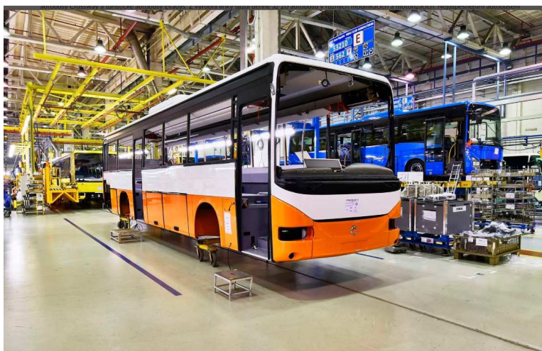
Obrázek 11: Opláštěná kostra autobusu Iveco Bus – lit. [16]
