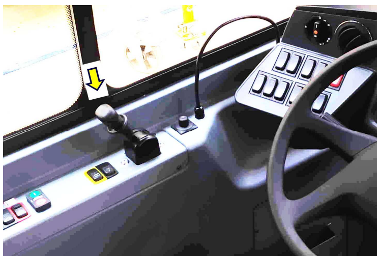
Obrázek 34: Páka pružinové brzdy. V zadní poloze je vůz zabrzděn, v přední odbrzděn. Před pohybem do odbrzděné polohy se musí páka nebo zajišťovací kroužek (zde) přizvednout – lit. [23]
