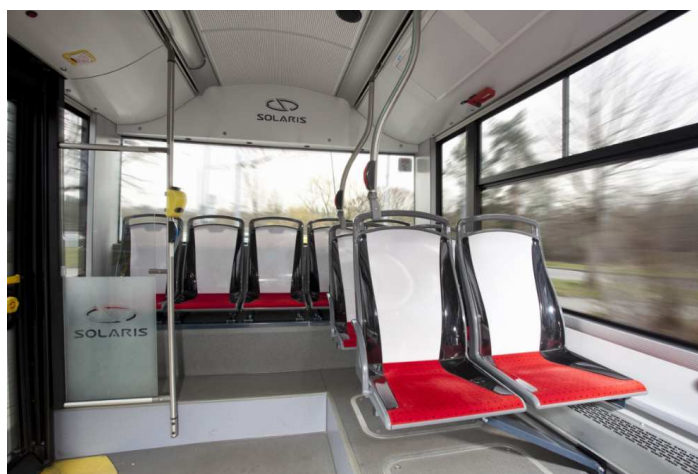
Obrázek 20: Interiér trolejbusu 27 Tr (Solaris) se sedadly kotvenými do bočnice. Pod sedadlem je šikmá vzpěra – lit. [1]
