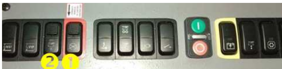
Obrázek 76: Spínače trolejbusů 30Tr a 31Tr – SOR: havarijní vypnutí s červeným rámečkem (1); deaktivace sběračů s černým rámečkem (2) – lit. [41]
