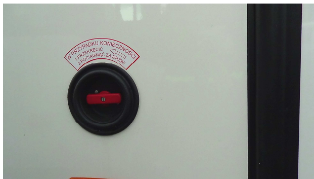
Obrázek 70: Vnější ovladač dveří (autobus SOR určený pro vývoz do Polska). Ovladač není překryt průhledným krytem – lit. [17]
