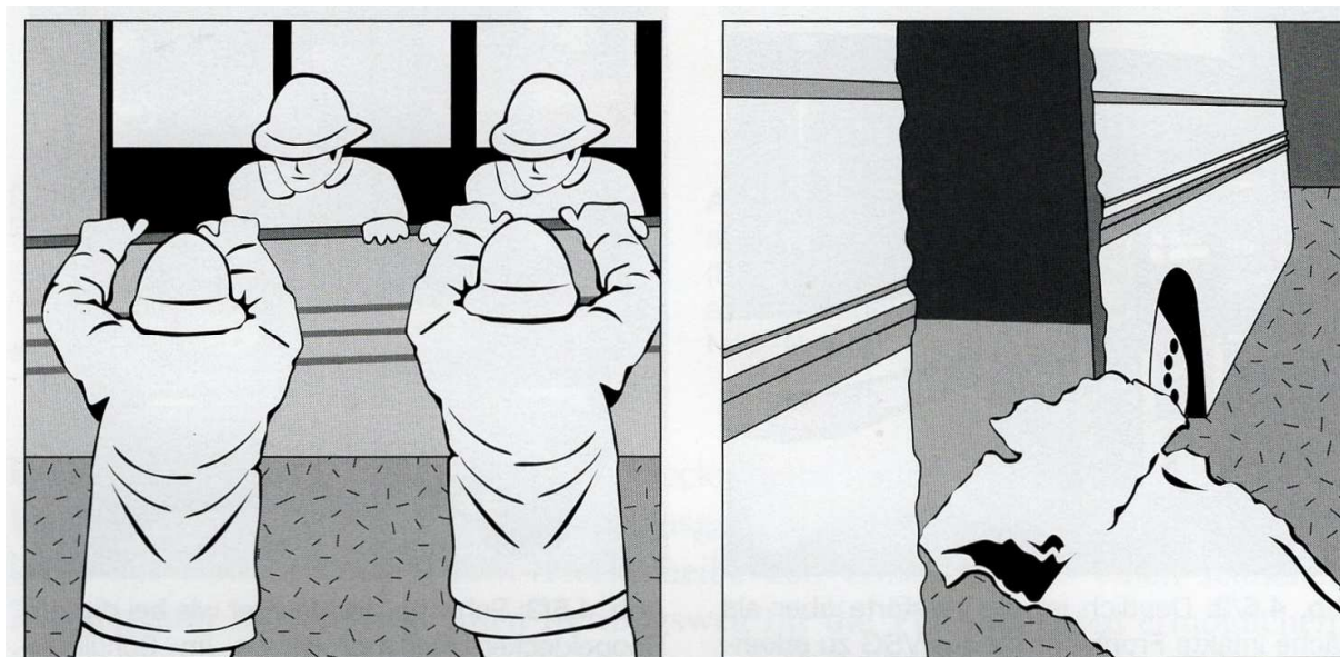
Obrázek 71: Získání přístupu do vozidla rozřezáním bočnice
