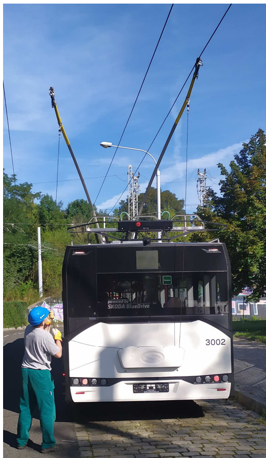
Obrázek 79 Sběrače lze umístit vedle troleje – lit. [41]
