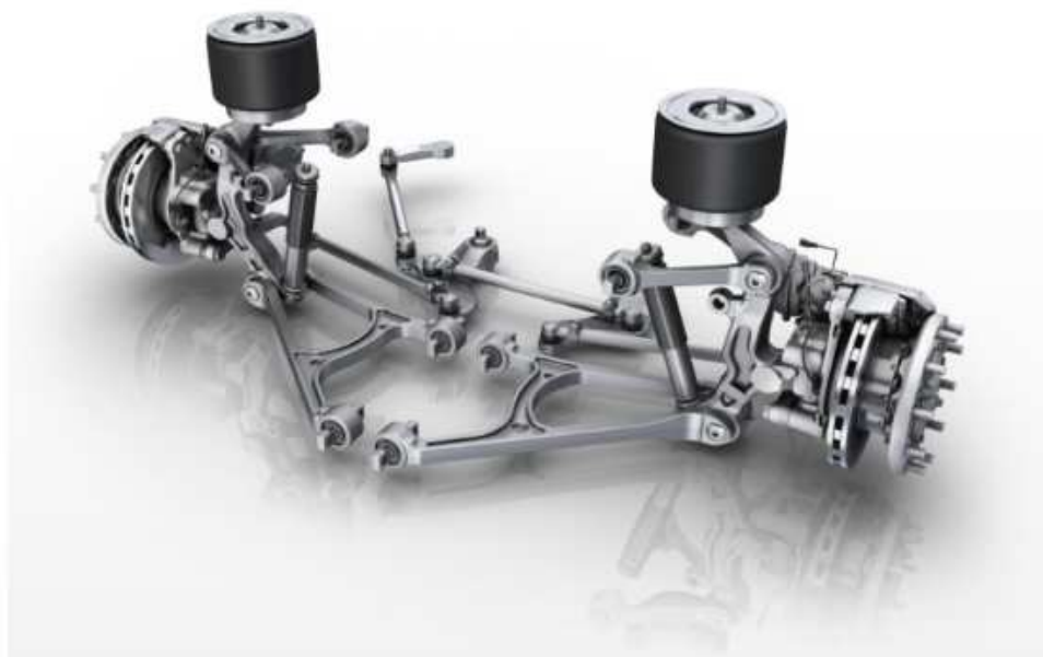
Obrázek 21: Přední řízená náprava typu ZF 82EC – lit. [9]
