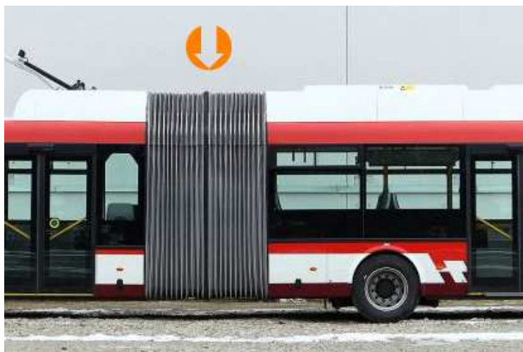
Obrázek 12: Pružný kryt spoje dílů kloubového trolejbusu – vnější pohled – lit.[1]
