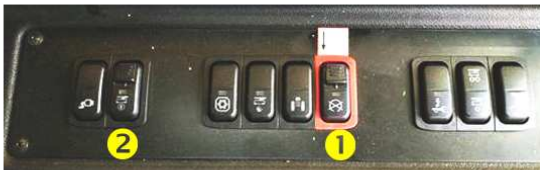
Obrázek 77: Spínače trolejbusů 32Tr a 33Tr – SOR: havarijní vypnutí s červeným rámečkem (1); deaktivace sběračů s černým rámečkem (2) – lit. [41]
