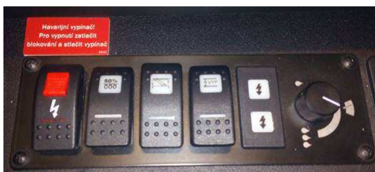
Obrázek 74: Spínač nouzového odpojení trolejbusů 26Tr a 27Tr (zcela vlevo) v karosérii Solaris Urbino
