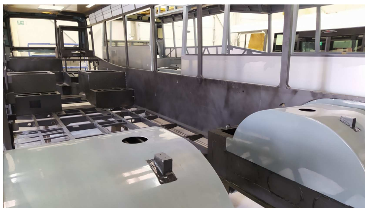
Obrázek 10: Kostra skříně trolejbusu 32Tr - SOR – lit.: [17]
