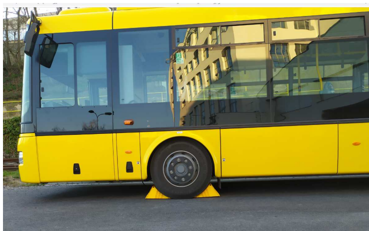
Obrázek 69: Trolejbus zajištěný proti oboustrannému pohybu zakládacími klíny – lit: [41]
