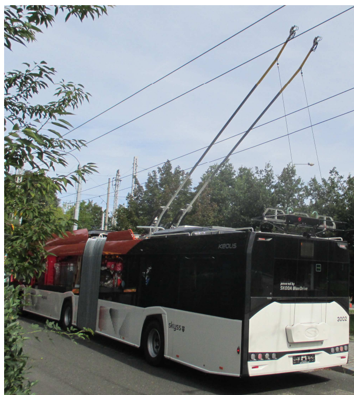
Obrázek 80 Volně ložené sběrače vedle trolejí – lit. [41]
