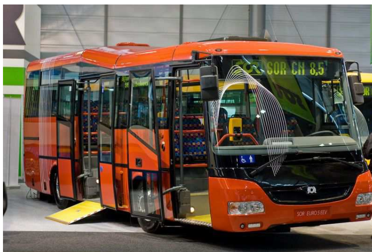
Obrázek 30: Náklon autobusu s využitím funkce kneeling – lit. [23]
