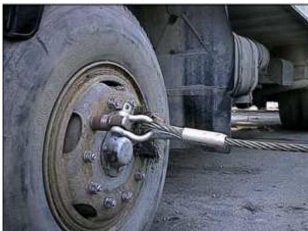
Obrázek 66: Prodloužená matice kolového šroubu, která zamezí poškození boku trolejbusu při jeho zvedání - lit. [32]
